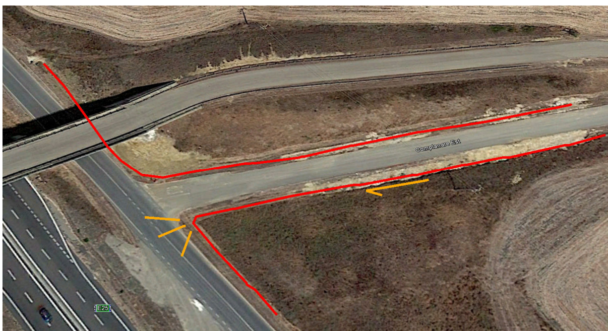
Figura 20: situazioni di deflusso in occasione di forti precipitazioni, delle acque di drenaggio poste a valle del rilevato sez. 34 (complanare Est)
